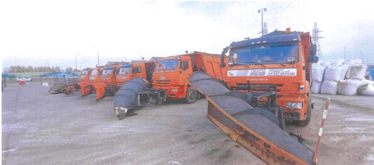
Фото №25. Комбинированные дорожные машины на базе КАМАЗ для зимнего содержания Объекта
